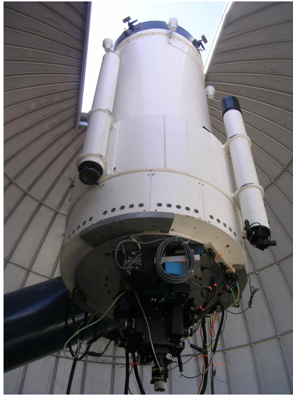
De Cassegrain focus onderin de 0.91 m SARA spiegeltelescoop kan uitgerust worden met diverse ccd-mozaïeken, een lage resolutie spectrograaf of een polarimeter. Foto: Philip Corneille .
